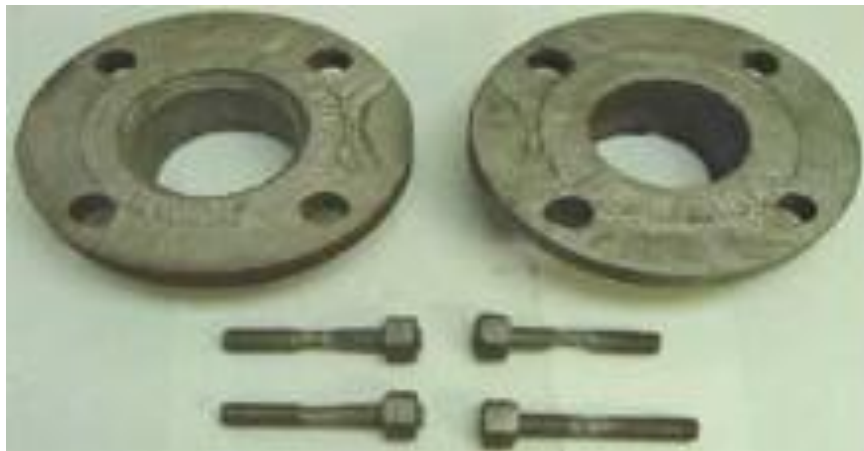
شكل (4) يوضح التآكل التشققي
