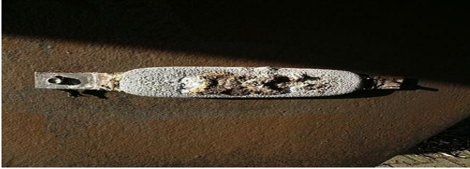
شكل (11) يوضح الحماية المهبطية باستخدام الزنك على بدن السفينة
